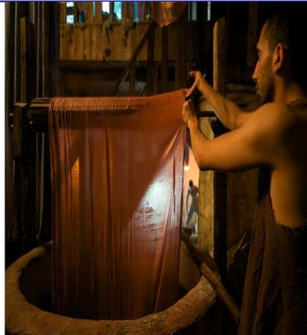
Gli abiti venivano successivamente immersi nell'acqua con la tintura e poi tramite un rullo, portate in superficie e lasciate asciugare sullo stenditoio.
